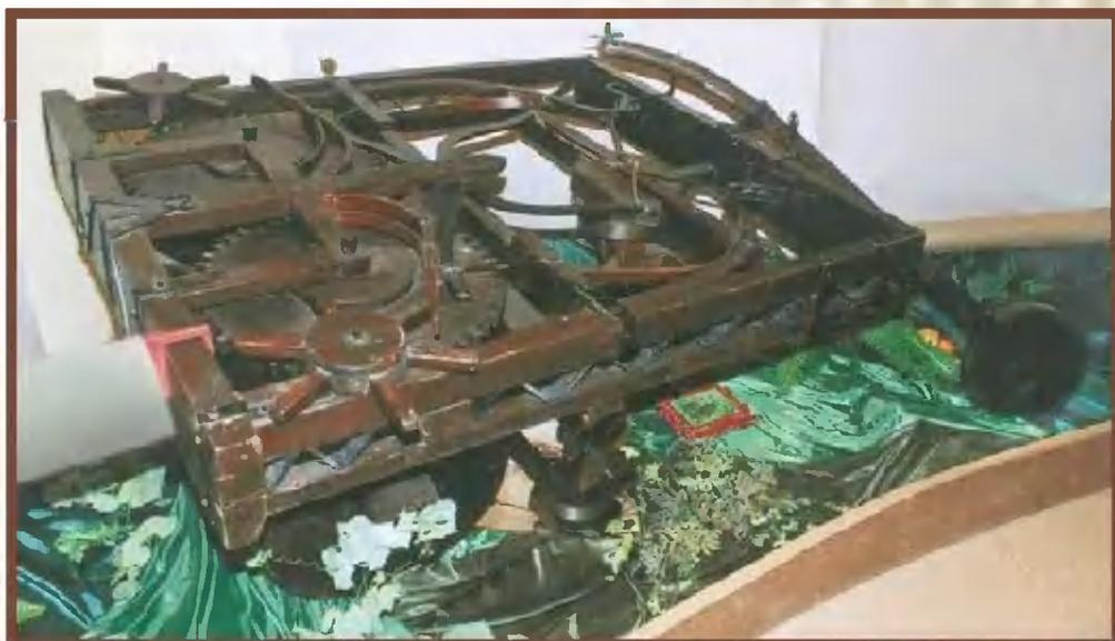
Один из прототипов самодвижущегося экипажа, приводимый в действие пружиной.
