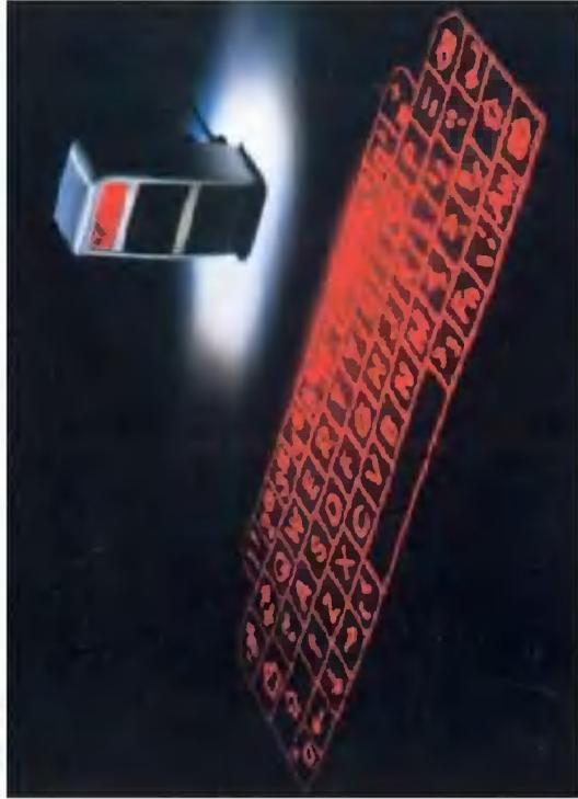
**ВИРТУАЛЬНУЮ КЛАВИАТУРУ** начала продавать известная компания Siemens. Клавиши проецируются на поверхность рабочего стола перед пользователем проектором системного блока. А специальные детекторы фик-
